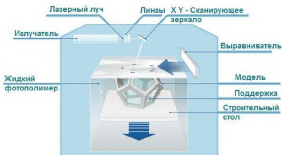
Рисунок 47 – Схема процесса SL
