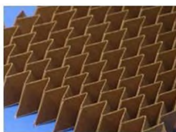
Образец наполнителя типа z-гофр из органопластика
