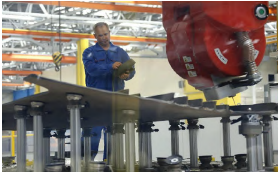
Рисунок 37 - Фрезерование на гибком столе (вакуумных актуаторах)
