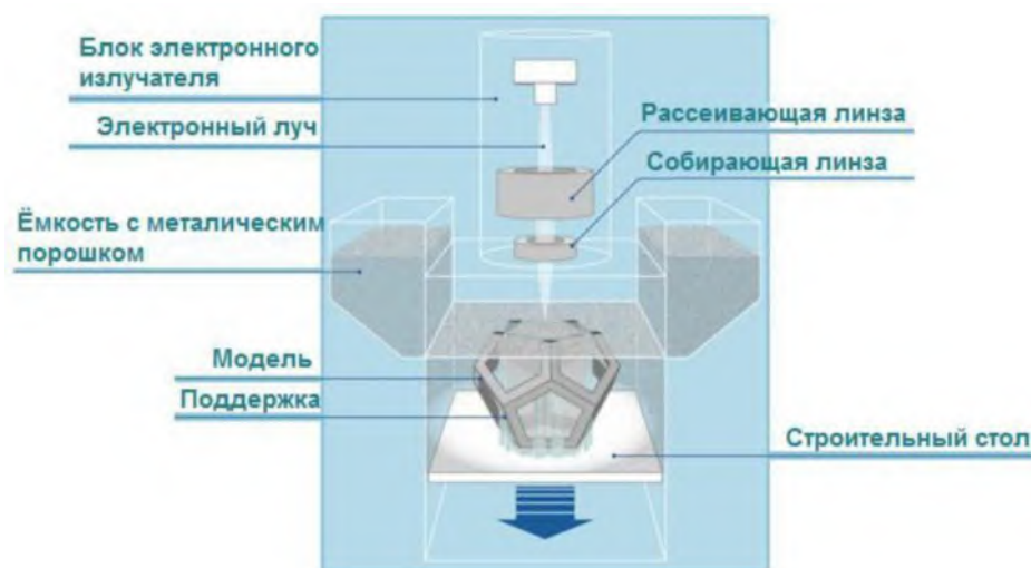
Рисунок 43 – Схема процесса EBM
