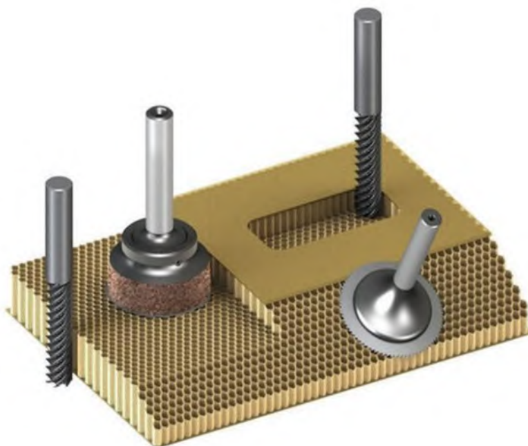
Рисунок 30 – Режущий инструмент применяемый при обработке сотовых конструкций
