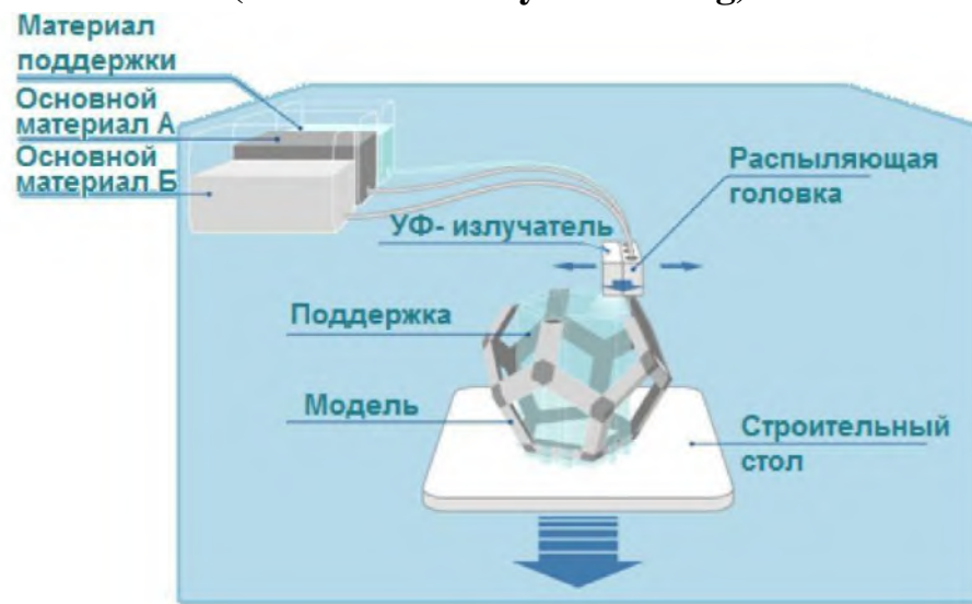
Рисунок 47 – Схема процесса PPJ
